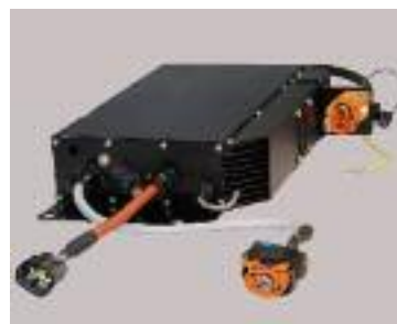
L'ELIPS 2000W avec DC/DC intégré 400W, un chargeur spécial d'IES Synergy pour petites voitures électriques.
